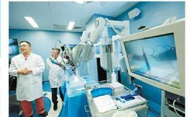
●機械人輔助手術系統中的機械手臂，可多軸向運動，模仿人體手腕轉動和抓握動作，操作靈巧，較傳統微創手術更為精準。
