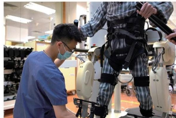
■張浩賢(左)替病人以機械輔助步態訓練 (RAGT)，練習步行。(圖片由醫管局提供)
