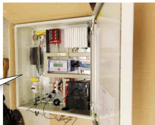
震動感應器收集的數據，讓醫院及承建商監察因樁柱工程而引致的震動程度。
